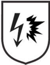
Bild 2 - Symbol Schutz gegen die thermischen Effekte eines Störlichtbogens
