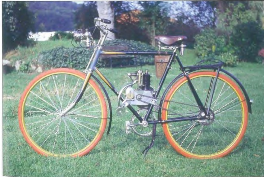
Im Gegensatz zu vielen Konkurrenten besaß der Paqué-Motor schon Kettenantrieb
