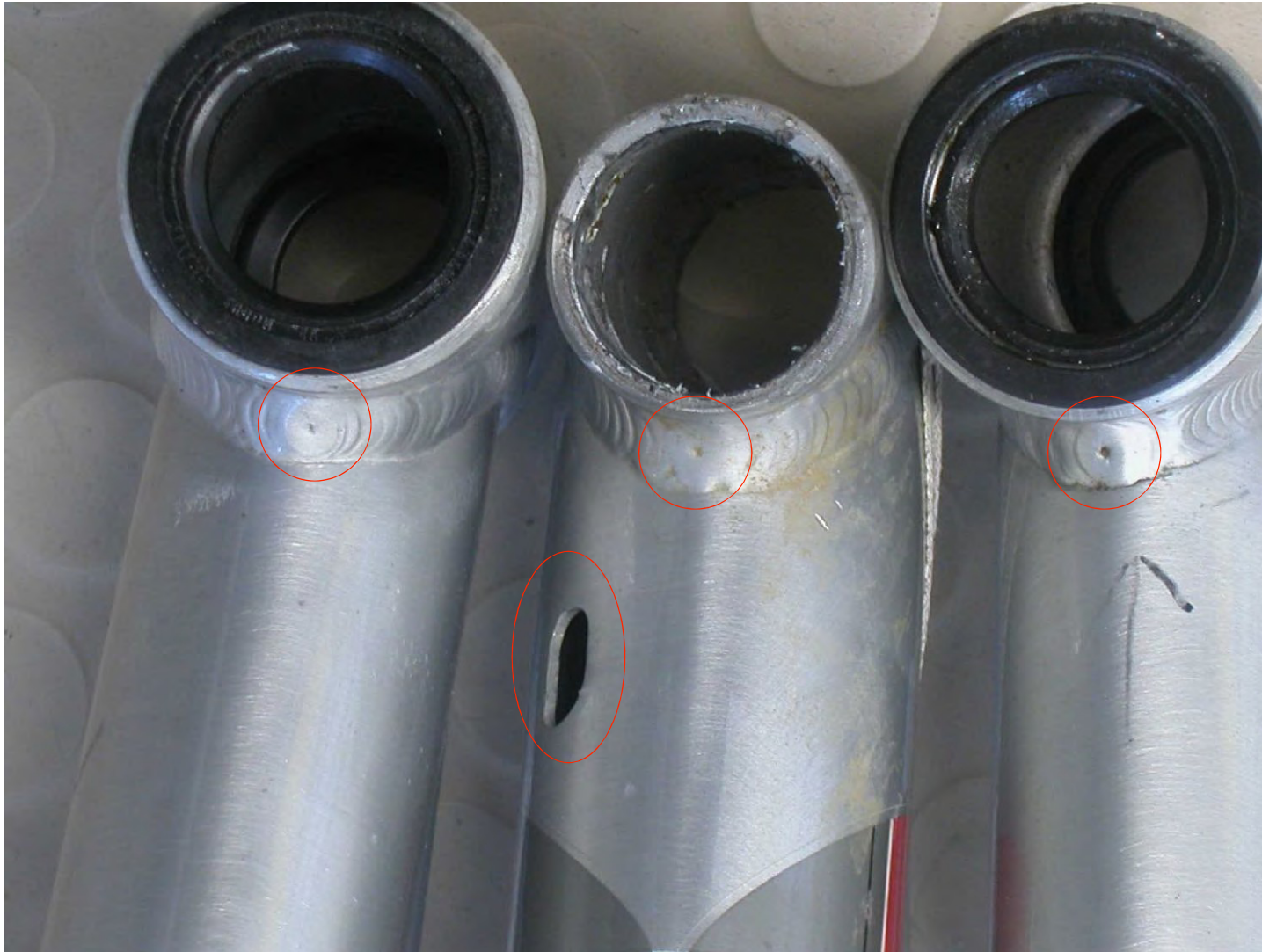
Fertigungsfehler Einbrandkerbe auf 6 Uhr bei dem hoch belasteten Bereich
