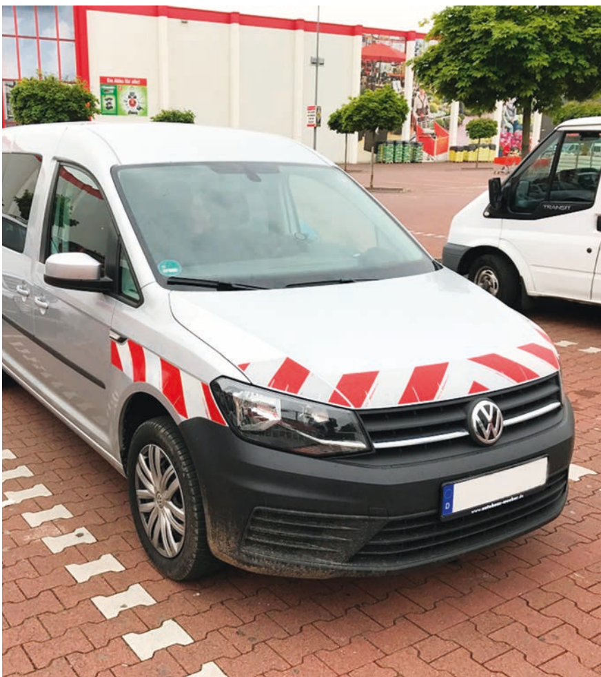
Bei längeren Arbeiten im öffentlichen Straßenraum müssen Fahrzeuge Warnmarkierungen haben.
