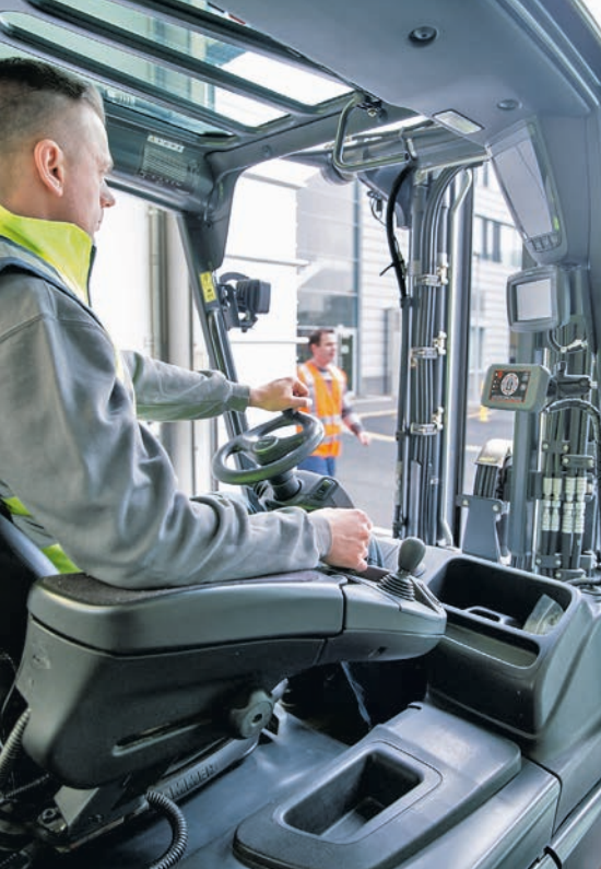
Das Antikollisionssystem auf Transpondertechnik warnt vor dem Fußgänger.
