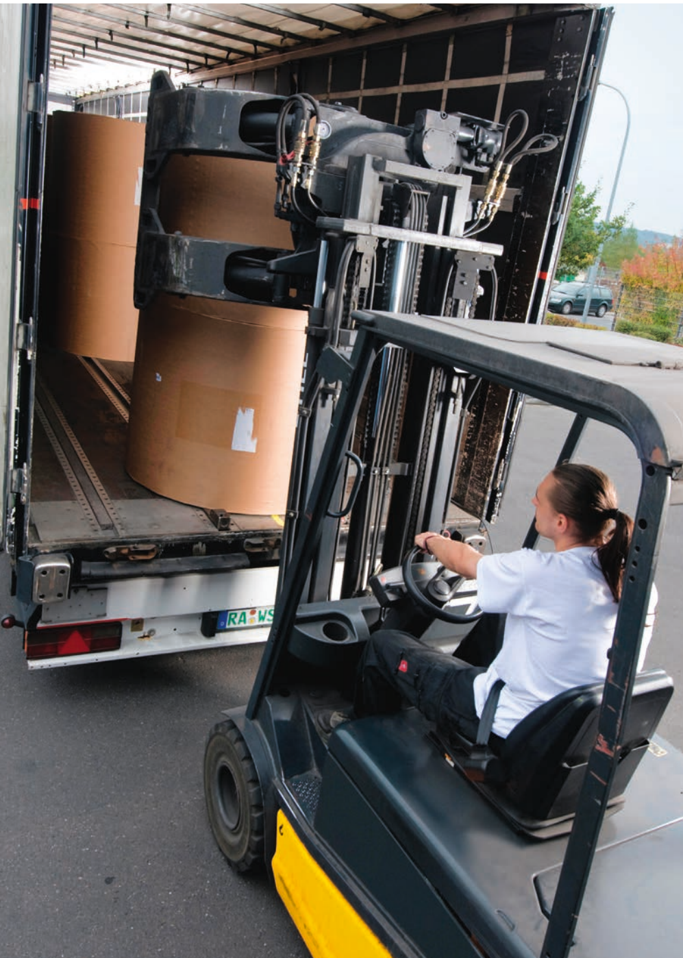
Der Gefahrenbereich eines Gabelstaplers. Hier sieht der Fahrer nicht, ob sich jemand nähert.
