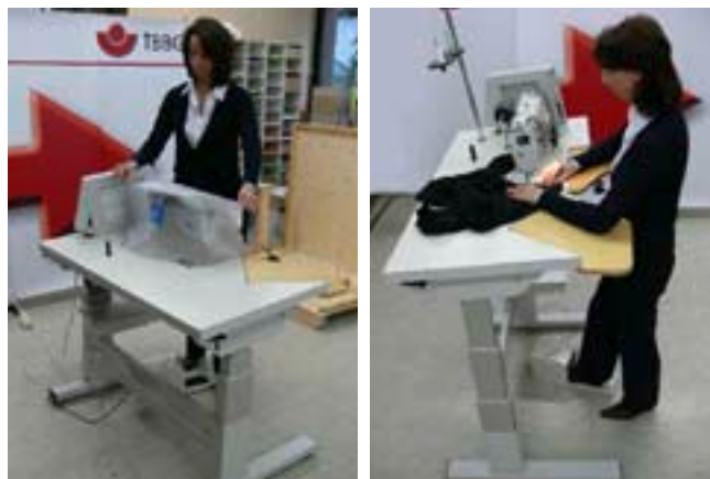
Abb. 2: Ergonomisches Nähen – Näharbeitsplatz zum Ausleihen
