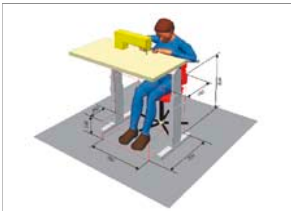
Abb. 1: Ergonomische Gestaltung der Näharbeit, hier: Beinfreiheit
