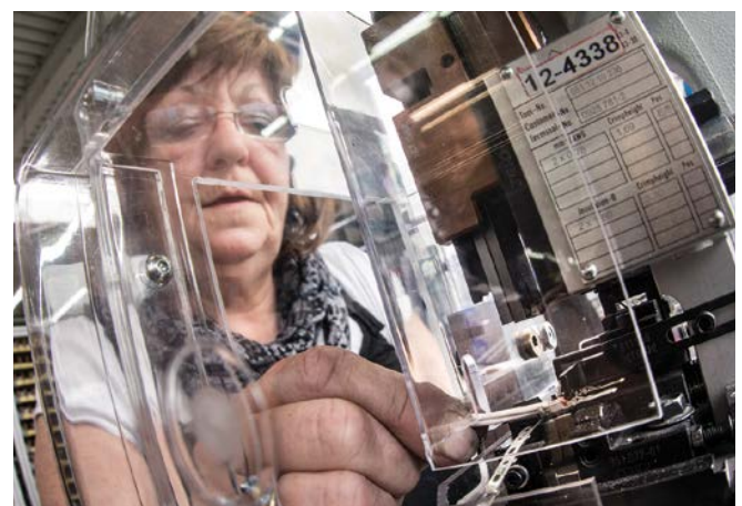
Das von Erich Scheible konstruierte Schutzsystem verhindert, dass die Hände beim Anschlagen von Kabel und Stecker gequetscht werden.
