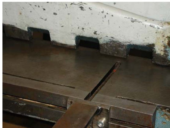
Detailansicht: Aussparungen im Niederhalter mit Zugriff auf den Messerbalken
