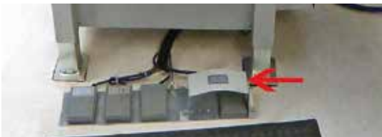
Fußschalter mit Übertunnelung (s. Pfeil), die vor dem zufälligen Auslösen schützt.
