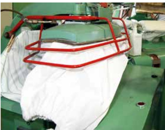
Bügelpresse mit korrekt justiertem Schutzrahmen. (Beispielbild)
