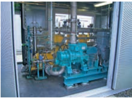
Für jede Anlagenkomponente – hier ein Gasverdichter (oben) und eine Aminwäschanlage (unten) – kann der Anlagenbetreiber mit der EX-RL-Beispieltabelle die Explosionsschutzmaßnahmen festlegen.
