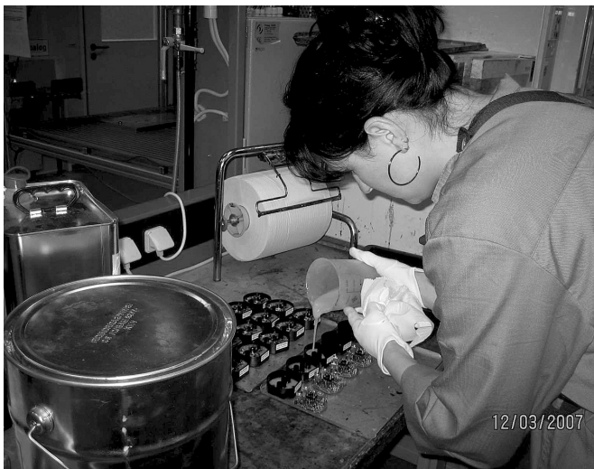
Bild 2. Vergießen elektronischer Bauteile von Hand.
