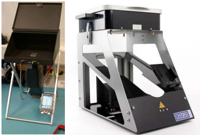
Bild 8: geschlossene Zusatzeinrichtungen für Kleinteile
