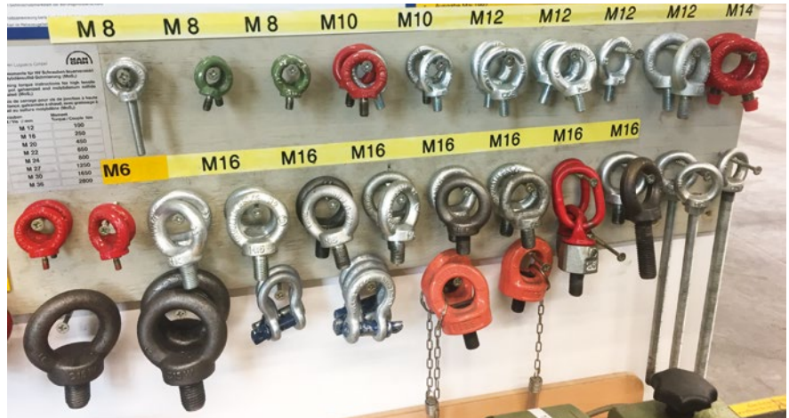
Vorbildlich: So sollten Lastböcke, Ringschrauben sowie Schäkkel aufbewahrt werden. Einrichtungen zur Lastaufnahme sind übrigens regelmäßig zu prüfen.
